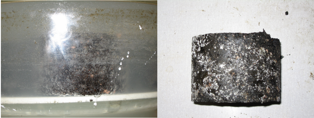
Bild 1. T.V Saltmätning av provkropp i pyknometer i undertryck av 40mbar. T.H saltmättad provkropp med saltavlagring på ytan.
